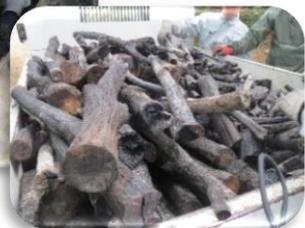
3月に日応寺の地域の方々で炭焼き小屋で炭焼きをしました! 3日間窯の中で火を燃やし続け、焚口を密閉して消化したあとに窯から炭を取り出します。このように炭を作る方法を「窯内消化法」というそうです。4月、いざ炭出し! 焼く前には窯いっぱいに入っていた木材は炭出しの時にはぎゅっと小さくなっていました。トラックの荷台から溢れんばかりの炭ですが、うまく焼けず炭になっていない部分もありました…。炭の焼け具合は音で判断します。炭同士を軽くぶつけて“キンキン”と高い音が出ると、しっかり焼けている証拠です!
